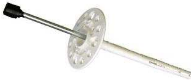
Rys. 2. Przyjęty łącznik mechaniczny – średnica całkowita łącznika 10 mm, średnica rdzenia ze stali ocynkowanej 8 mm, długość 200 mm, w tym 50 mm zakotwienia
