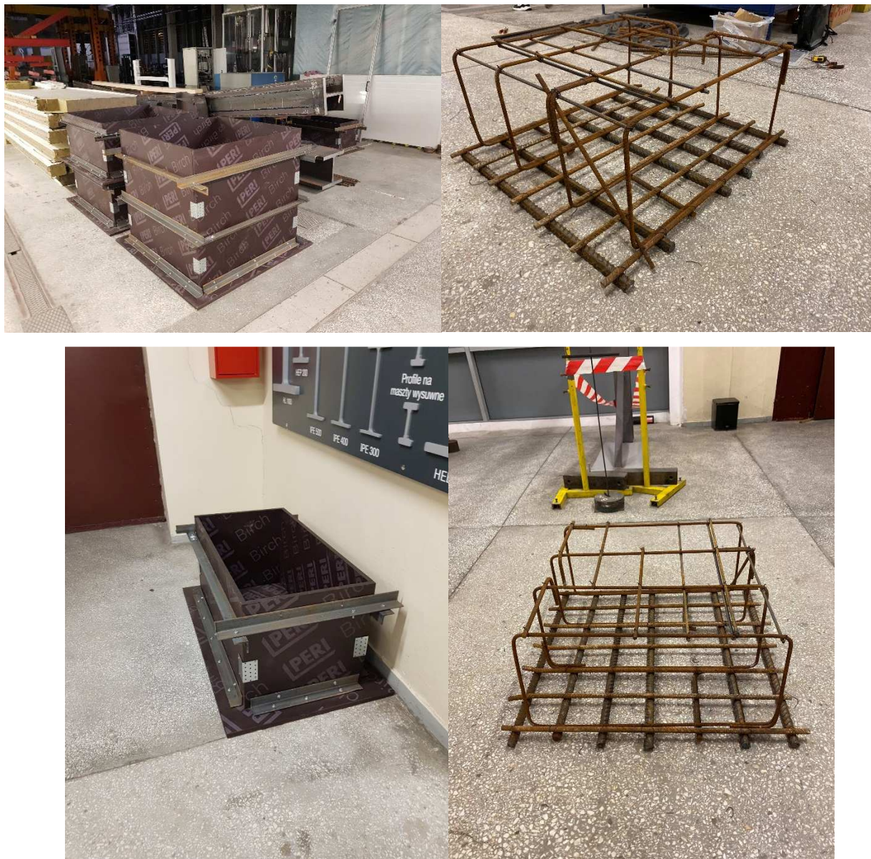
Rys. 3. Deskowania do betonowych elementach próbnym oraz przykład inkluzji w postaci zbrojenia z prętów żebrowanych.
