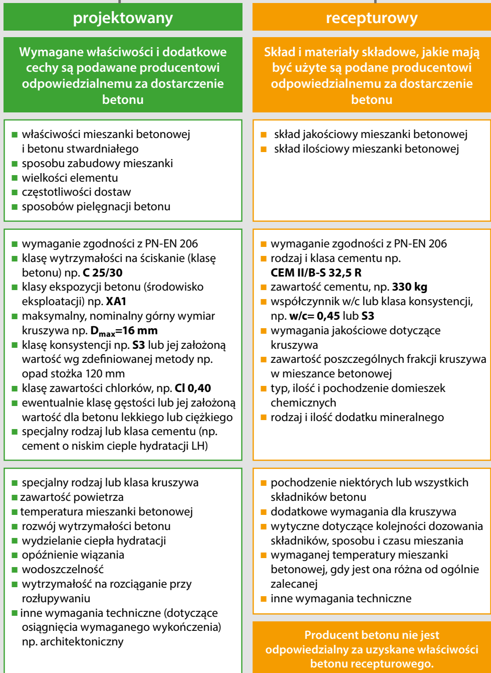
Rys. 16. Specyfikacja betonu projektowanego i recepturowego
