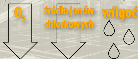
Rys. 4. Mechanizm niszczenia betonu w wyniku korozji chlorkowej
