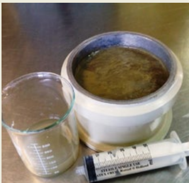
Rys. 3. Zbieranie wody z powierzchni mieszanki betonowej
