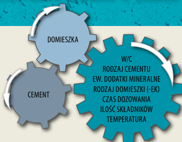
Rys. 5. Kształtowanie kompatybilności układu domieszka - cement
