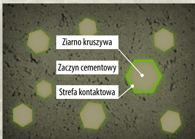
Rys. 2. Uproszczony model betonu
