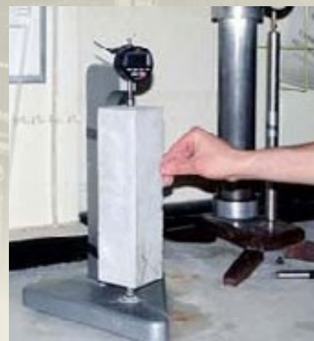
Rys. 9. Pomiar długości próbek z betonu
