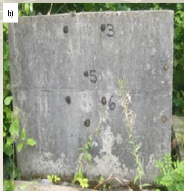
Rys. 9. Reakcja alkalia-krzemionka: a) przykład destrukcji betonu zwykłego, b) beton z dodatkiem popiołu lotnego
