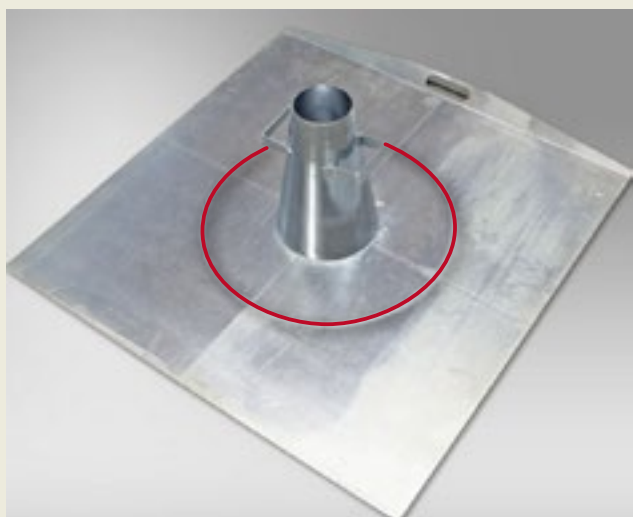
Rys. 5. Stożek do pomiaru lepkości mieszanki betonowej SCC (czerwonym kolorem zaznaczono okrąg o średnicy 500 mm)
