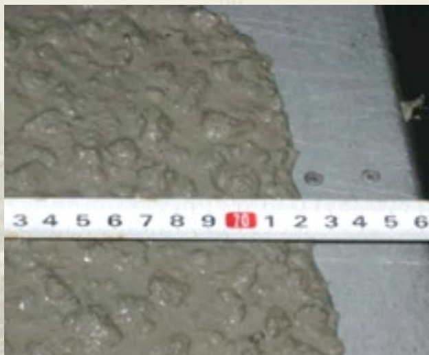
Rys. 4. Pomiar konsystencji mieszanki betonowej SCC
