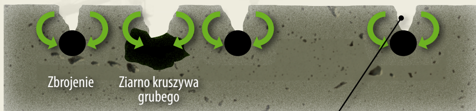
Rysy powstałe w skutek osiadania plastycznego betonu
