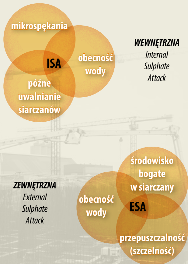
Rys. 5. Rodzaje i przyczyny korozji siarczanowej
