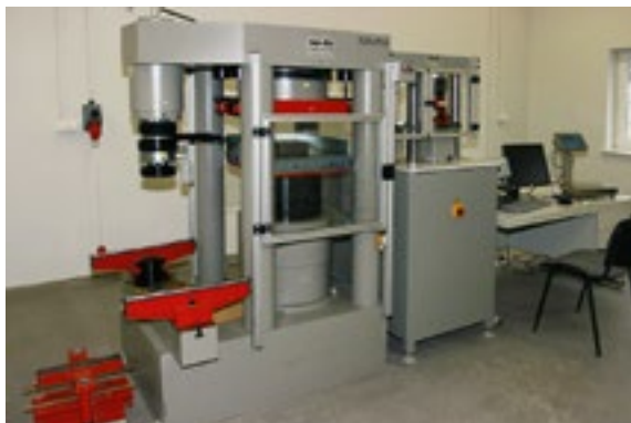
Rys. 2.16. Prasa do badań wytrzymałości betonów i drobnowymiarowych elementów prefabrykowanych
