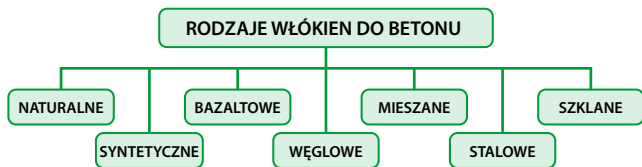
Rys. 6.31. Klasyfikacja włókien stosowanych do betonu
