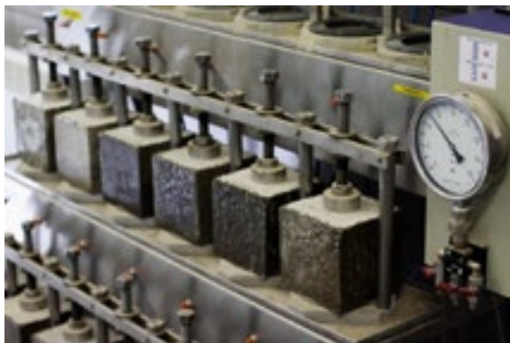
Rys. 2.15. Laboratorium w Dąbrowie Górniczej – badanie głębokości penetracji wody pod ciśnieniem
