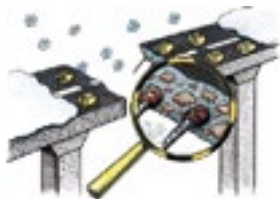
Rys. 6.58. Korozja stali spowodowana agresją jonów chlorkowych (ABC Betonu – wyd. Polski Cement)
