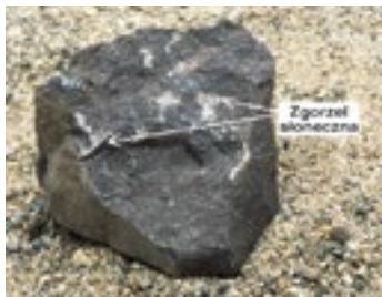
Rys. 6.13 Zgorzel słoneczna bazaltowa
