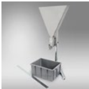
Rys. 6.44. V-lejek (V-funnel), 1) – zawiasowe lub przesuwne szczelne zamknięcie
