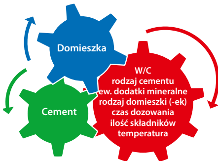
Rys. 6.21. Czynniki decydujące o kompatybilności domieszek chemicznych
