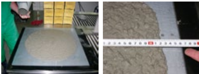
Rys. 6.64. Badanie konsystencji mieszanki samozagęszczalnej – pomiar rozplywu stożka
