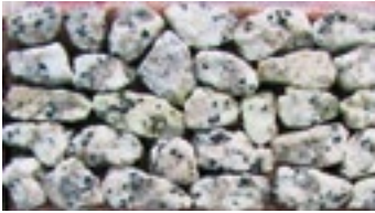
Próbka do badania PSV
