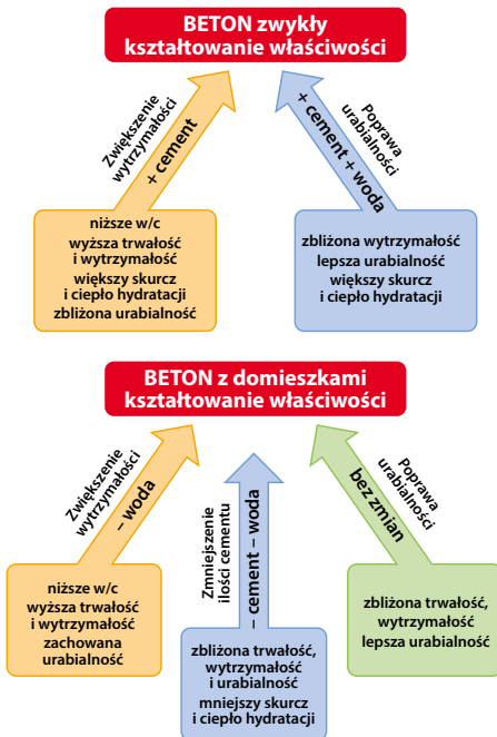
Rys. 6.17. Możliwości kształtowania właściwości betonu z domieszkami upłynniającymi (superpalstyfikatorami).
