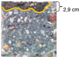
Rys. 6.51. Pomiar głębokości penetracji wody pod ciśnieniem, beton z cementu CEM III/A 32,5N, w/c=0,46
