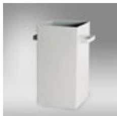
Rys. 6. 41. Badanie konsystencji metodą oznaczania stopnia zagęszczalności
