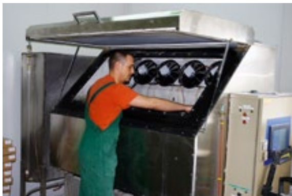
Rys. 2.17. Badanie odporności betonu na działanie mrozu metodą zwykłą
