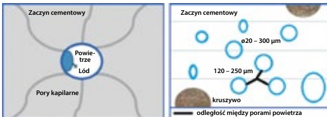
Rys. 6.18. Schemat napowietrzenia betonu i rozmieszczenie porów
