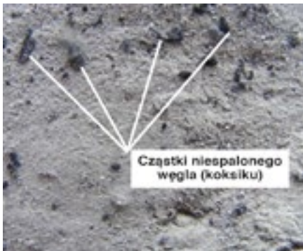
Rys. 6.23. Pozostałość niespalonego węgla (straty prażenia) w popiele lotnym
