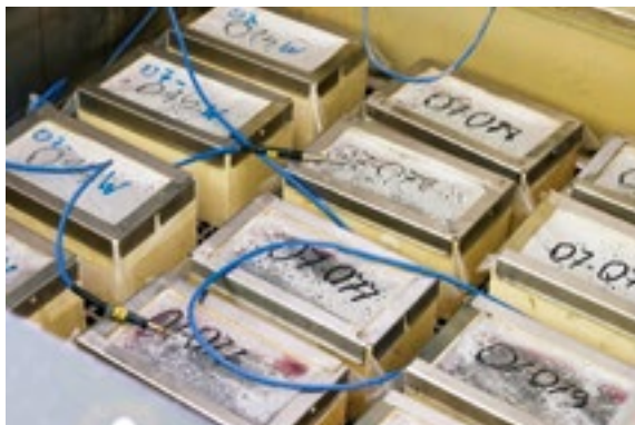
Rys. 6.53. Badanie mrozoodporności w obecności soli odladzających
