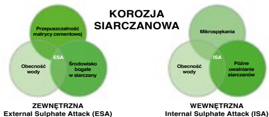
Rys. 6.61. Rodzaje i przyczyny korozji siarczanowej
