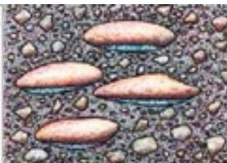
Rys. 6.8 b) Soczewki wodne pod płaskimi ziarnami kruszywa
