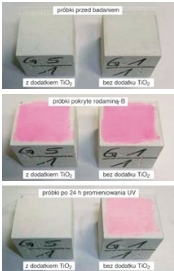
Rys. 6.74. Właściwości fotokatalityczne cementu TioCem®
