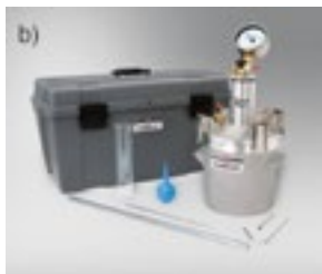
Rys. 6.48. Badanie zawartości powietrza w mieszance betonowej a) schemat aparatu i badania metodą słupa wody, b) ciśnieniomierz
