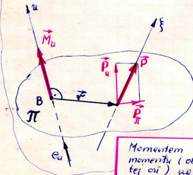
Dowód: siła  $\vec{P}$  no osi  $\xi$  oraz osi  $u$  nie równoległe do osi  $\xi$  oraz nie przecinające nią się nigdy. Obierzemy przesuwanie  $\vec{r} \perp u$  i znajdziemy punkt przejęcia  $u$  z  $\vec{r}$ , punkt B. Siła  $\vec{P}$  zastępującą siłę  $\vec{P}_u \parallel u$  oraz siłę  $\vec{P}_{\xi}$  będącą rzutem  $\vec{P}$  na  $\vec{\xi}$ . Oznacza to, że  $\vec{P}_u \perp \vec{P}_{\xi}$  oraz  $\vec{P} = \vec{P}_u + \vec{P}_{\xi}$ .
