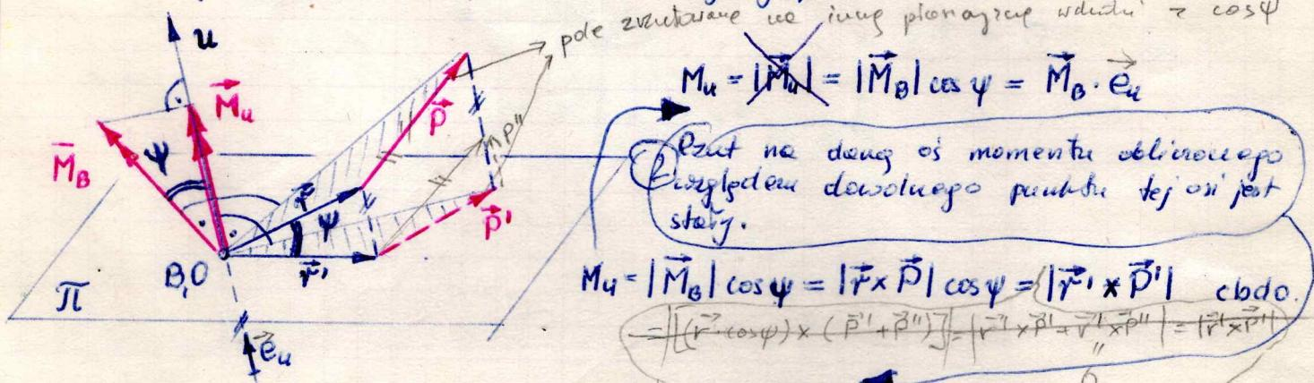
Decja jest więc  $\vec{P}$  na osi  $\perp$  oś osi u niewiadomej i nieznajomością z osią  $\perp$ . Na osi u obieramy punkty  $B$  i  $B'$ . Momenty masy  $\vec{P}$  względem tych punktów są ogółem różne.
