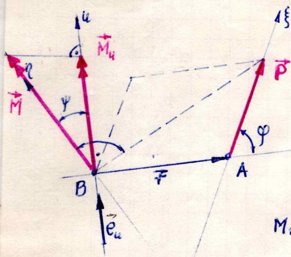
Przeprzesunięcie przez punkt B dowolnej osi  $u$  o kierunku równoległy wektorowi  $\vec{e}_u$ , tworzący z osią  $u$  kąt  $\psi$ .
