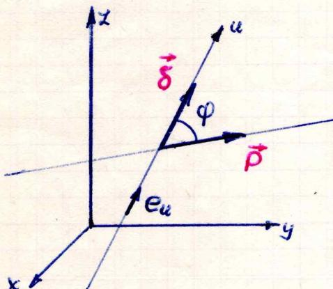
Praca siły  $\vec{P}$  na przemieszczeniu  $\vec{\delta}$  jest równa ilorazowi skalarowemu wektorów  $\vec{P}$  i  $\vec{\delta}$ ; wynik skalarem
