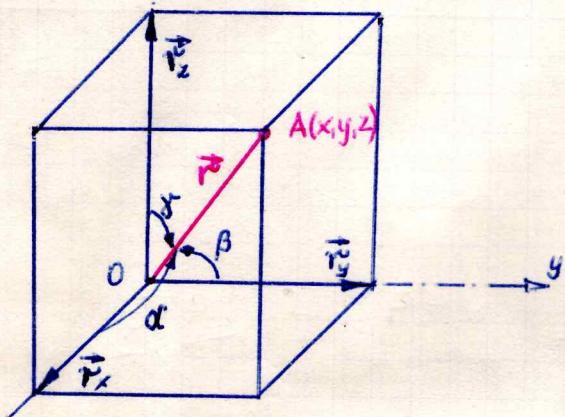
Położenie punktu  $A$  w przestrzeni można opisać ze pomocą trzech współrzędnych  $(x, y, z)$  lub ze pomocą wektora wiodącego  $\vec{r} = \vec{OA} = \vec{r}(r_x, r_y, r_z)$  o współrzędnych  $(r_x, r_y, r_z)$  zwanych mianem rzutów wektora  $\vec{r}$  na osie układu, przy czym  $r_x = x, r_y = y, r_z = z$ .
