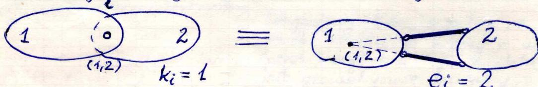
Przegub łączący dwie terce nazywamy przegubem jednokrotnym.
