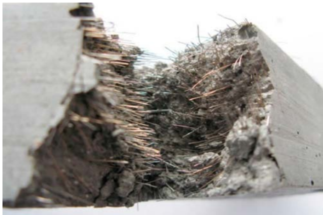
Rys. 5.145. Przełam próbki fibrobetonu
