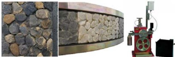
Rys. 4.11. Próbka i urządzenie do badania odporności na polerowanie (PSV)
