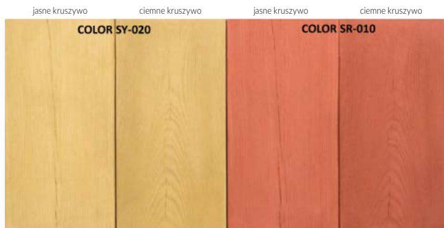
Rys. 5.157. Wpływ koloru kruszywa na wybarwienie betonu/zaprawy
