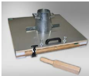
Rys. 5.52. Badanie konsystencji metodą stolika rozptywowego
