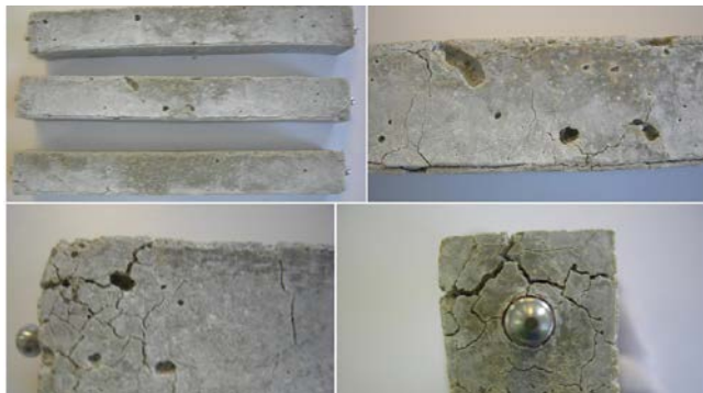
Rys. 3.21. Beleczki z zaprawy z cementu portlandzkiego CEM I 42,5R po 52 tygodniach przebywania w roztworze \text{Na}_2\text{SO}_4 (liczne rysy i spękania)
