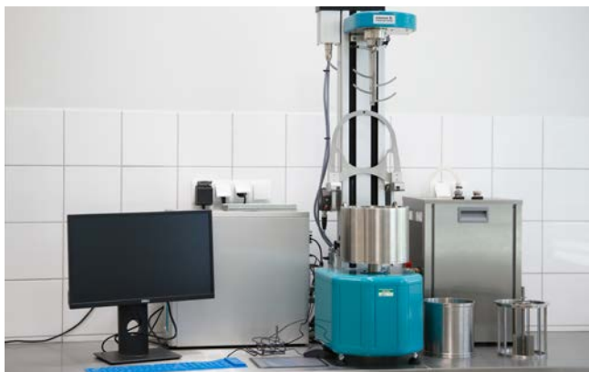
Rys. 2.25. Viskomat XL do badań właściwości reologicznych zapraw i mieszanki betonowej
