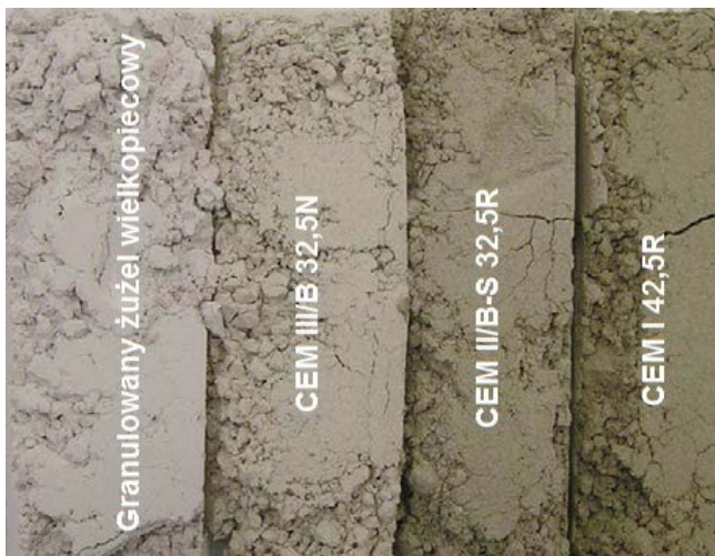
Rys. 3.24. Wpływ zawartości granulowanego żużla wielopieczowego na barwę cementu
