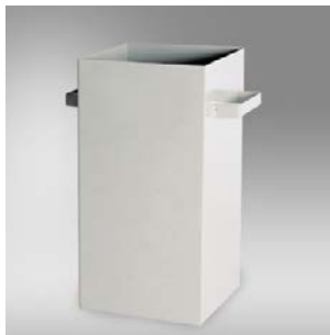
Rys. 5.51. Badanie konsystencji metodą stopnia zagęszczalności
