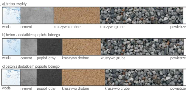
Rys. 5.41. Skład betonu a) beton zwykły bez popiołu lotnego, b) beton z dodatkiem popiołu, korekta zawartości kruszywa drobnego, c) beton z dodatkiem popiołu, korekta zawartości kruszywa
