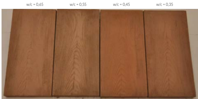
Rys. 5.156. Wpływ współczynnika wodno-cementowego na wybarwienie betonu/zaprawy
