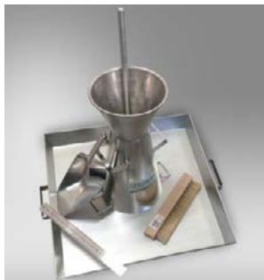
Rys. 5.50. Badanie konsystencji metodą opadu stożka
