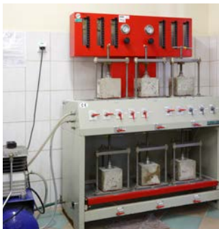
Rys. 5.79. Schemat badania głębokości penetracji wody oraz widok aparatury badawczej
