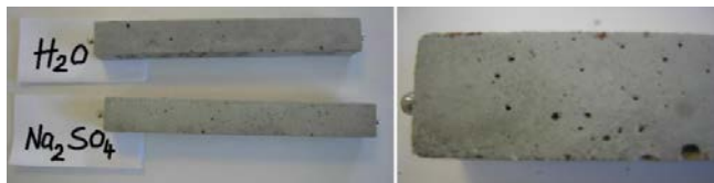
Rys. 3.22. Beleczyki z zapraw z cementu CEM V/A (S-V) 42,5N-LH/HSR/NA po 52 tygodniach przebywania w roztworze \text{Na}_2\text{SO}_4
