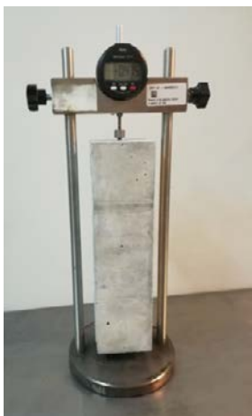
Rys. 4.13. Pomiar zmian liniowych próbki betonu
