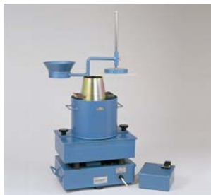
Rys. 5.54. Badanie konsystencji metodą Vebe
