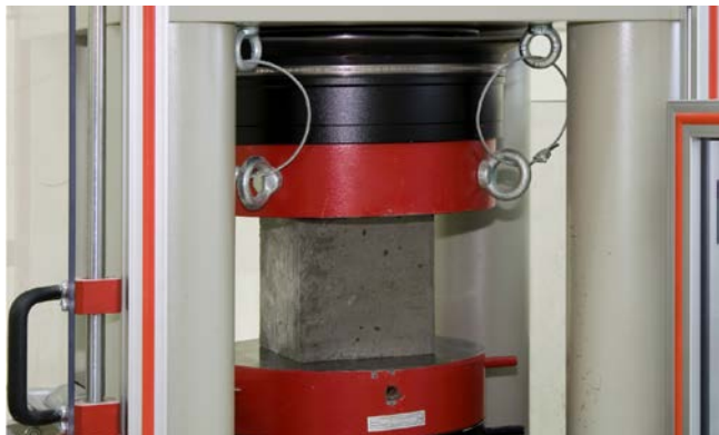
Rys. 5.74. Badanie wytrzymałości na ściskanie betonu
