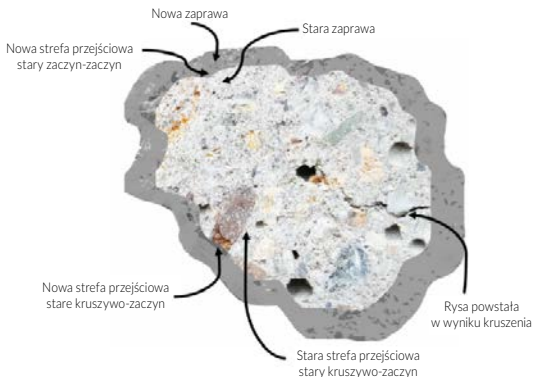
Rys. 5.163. Schemat ziarna kruszywa z recyklingu
