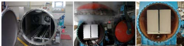
Rys. 5.133. Autoklaw wysokociśnieniowy do produkcji wyrobów z ABK
