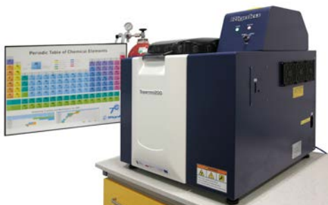
Rys. 2.16. Spektrometr XRF do określania składu chemicznego
