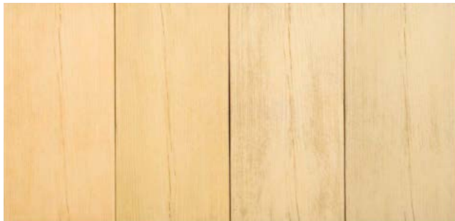
Rys. 5.154. Wpływ rodzaju cementu na wybarwienie betonu/zaprawy
