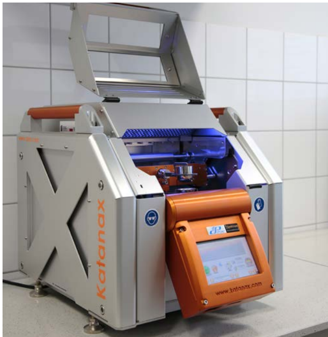
Rys. 2.17. Stapiarka do przygotowania próbek do analizy XRF
