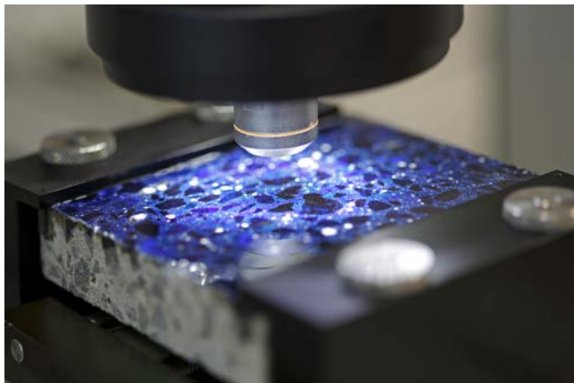
Rys. 2.30. Badanie charakterystyki napowietrzenia stwardniałego betonu
