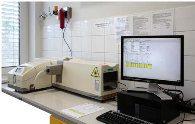
Rys. 2.22. Granulometr (do oznaczenia składu ziarnowego)
