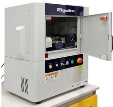
Rys. 2.18. Spektrometr XRD do określania składu mineralnego
