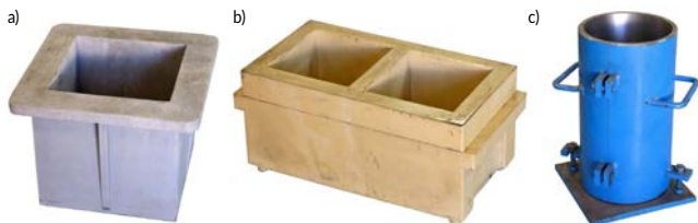
Rys. 5.73. Formy do przygotowania próbek betonu do badania wytrzymałości na ściskanie a) forma sześcienna 15cm, b) forma sześcienna podwójna 10cm, c) forma walcowa \varnothing 15cm
