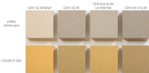
Rys. 5.153. Wpływ rodzaju cementu na wybarwienie betonu/zaprawy
