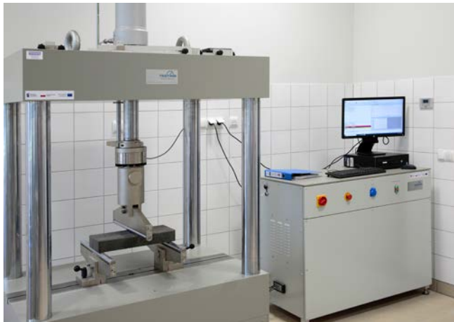
Rys. 2.27. Prasa do badania wytrzymałości na zginanie
