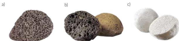
Rys. 5.127. Kruszywo lekkie a) naturalne - ziarno pumeksu, b) sztuczne z surowców mineralnych - spiekane z glin pęczniejących, c) odpadowe - szkło ekspandowane
