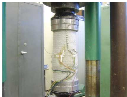
Rys. 26. Ścieżki odkształceń poprzecznych w funkcji obciążenia oraz obraz zniszczenia elementu 20M3_2 [35 w Z6] Oznaczenia: TMi_j : T – temperatura wstępnej ekspozycji, M – siatka PBO, i – liczba warstw siatki, j – numer próbki
