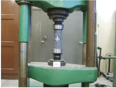
Rys. 1. Element wzmocniony jedną warstwą maty CFRP, na stanowisku badawczym [32 w Z6]
