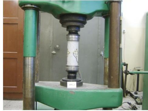
Rys. 2. Element wzmocniony jedną warstwą siatki PBO, na stanowisku badawczym [32 w Z6]
