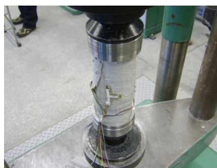
Rys. 25. Ścieżki odkształceń poprzecznych w funkcji obciążenia oraz obraz zniszczenia elementu 20M2_1 [35 w Z6]
