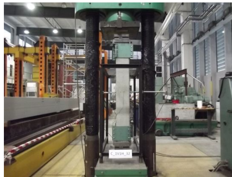
Rys. 29. Element na mimośrodku 32 mm ( h/6 ) na stanowisku badawczym [36 w Z6]
