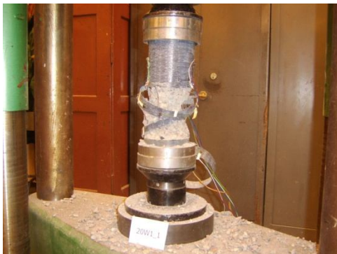
Rys. 5. Obraz zniszczenia elementu wzmocnionego jedną warstwą maty CFRP [32 w Z6]
