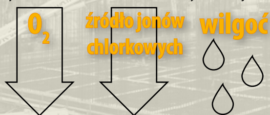
Rys. 4. Mechanizm niszczenia betonu w wyniku korozji chlorkowej
