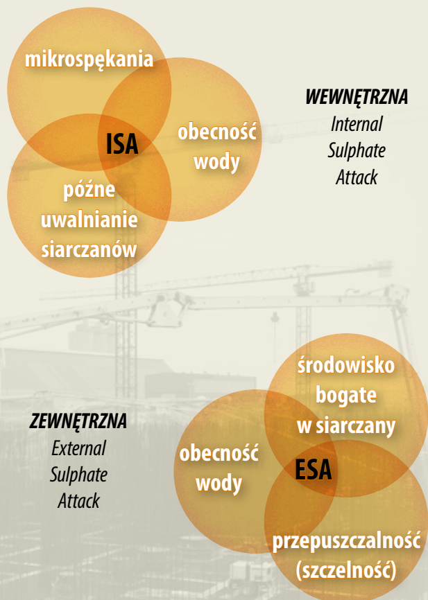
Rys. 5. Rodzaje i przyczyny korozji siarczanowej
