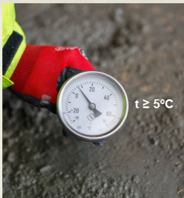
Rys. 1. Minimalna temperatura mieszanki betonowej
