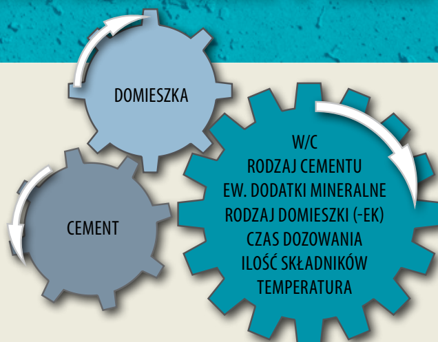
Rys. 5. Kształtowanie kompatybilności układu domieszka - cement
