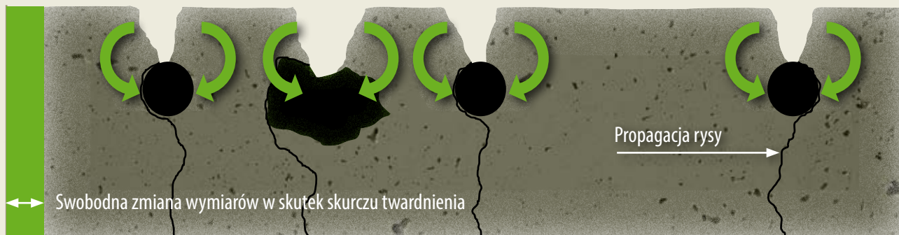
Rys. 3. Propagacja zarysowań w elementach utwardzonych
