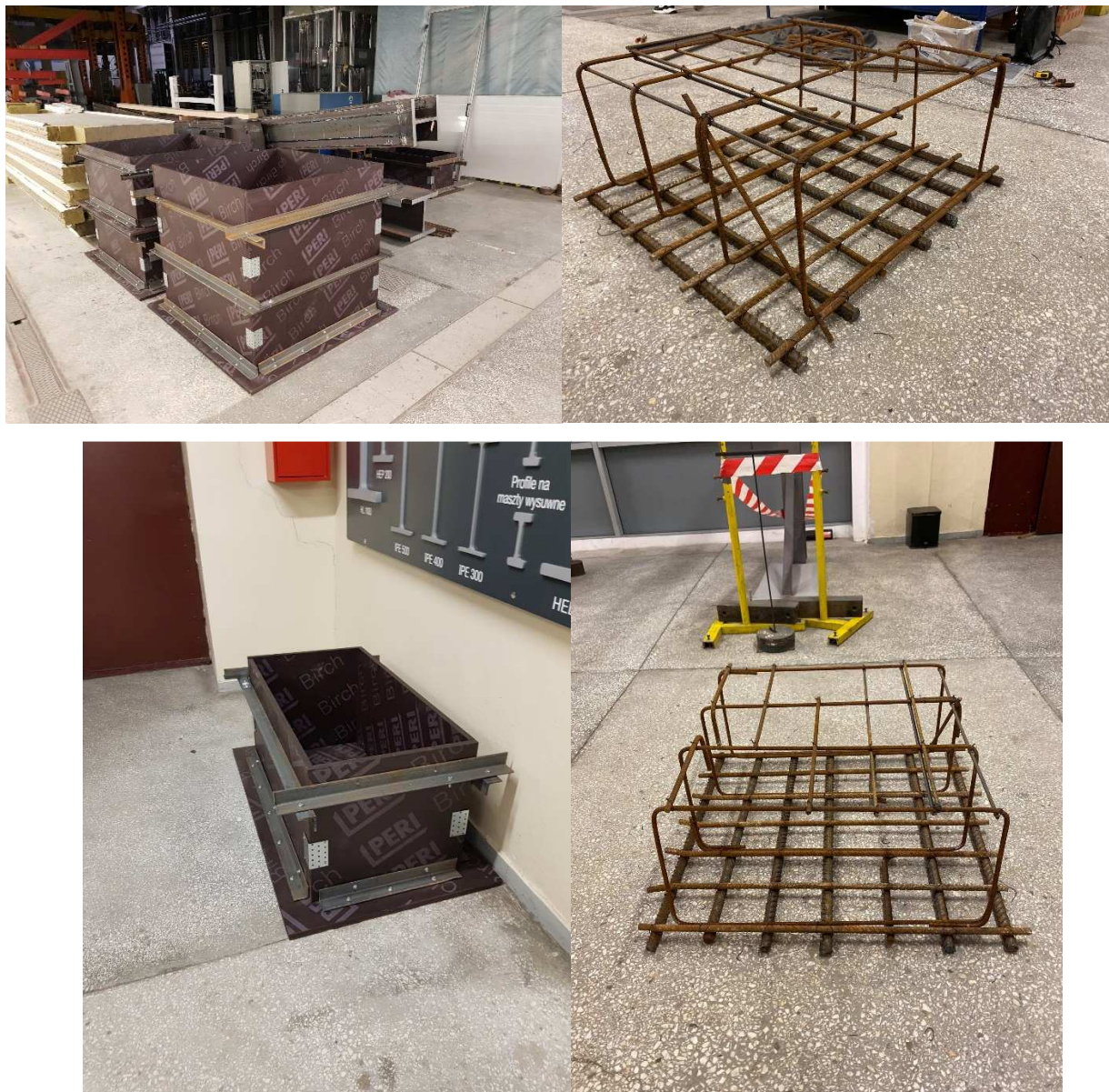
Rys. 3. Deskowania do betonowych elementów próbnych oraz przykład inkluzji w postaci zbrojenia z prętów żebrowanych.
