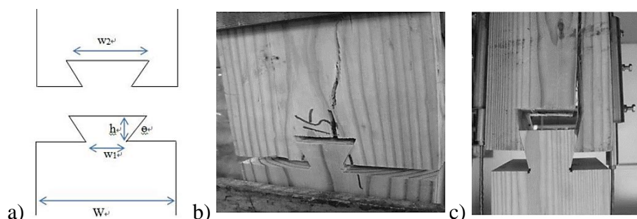
Rys. 3.48 Geometria badanego połączenia i przykładowe schematy zniszczenia wg [61] i [62]
