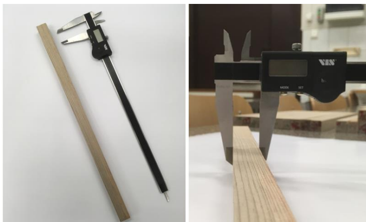
Rys. 4.2. Pomiar wymiarów i masy próbki do wyznaczenia gęstości drewna
