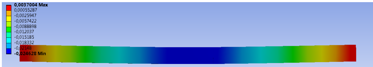
Rys. 5.131. Ugięcie (przemieszczenie w kierunku pionowym y) belki H przy sile 16 kN
