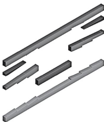
Rys. 3.8. Uproszczony model belki złożonej z XIV- wiecznego pałacu w Weronie [94]
