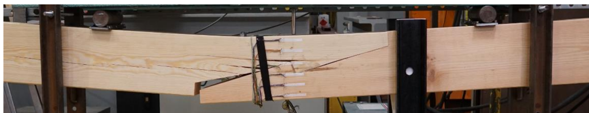
Rys. 5.35. Obraz zniszczenia belki E03
