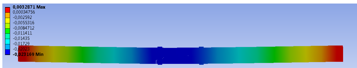
Rys. 5.112. Ugięcie (przemieszczenie w kierunku pionowym y) belki F przy sile 10 kN
