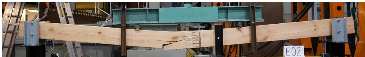
Rys. 5.103. Obraz zniszczenia belki E02
