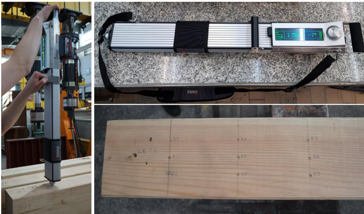
Rys. 4.8. Badania rezystograficzne za pomocą urządzenia RESI
