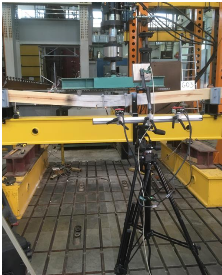
Rys. 4.15. Widok stanowiska do badań metodą cyfrowej korelacji obrazu dla przykładowej belki
