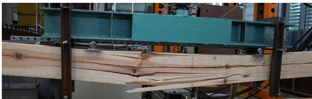
Rys. 5.6. Obraz zniszczenia belki A01
