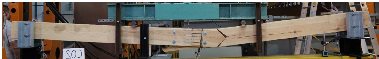
Rys. 5.87. Obraz zniszczenia belki C02
