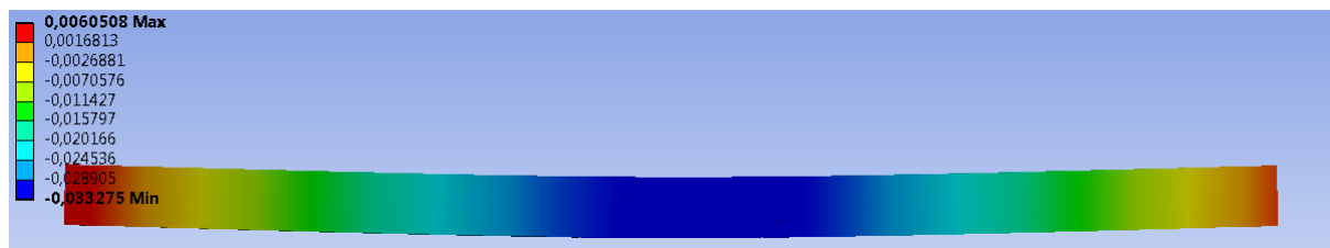
Rys. 5.99. Ugięcie (przemieszczenie w kierunku pionowym y) belki D przy sile 19 kN
