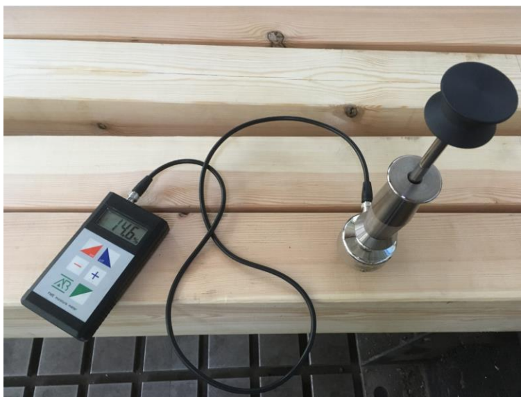
Rys. 4.1. Badanie wilgotności za pomocą urządzenia FMW moisture meter
