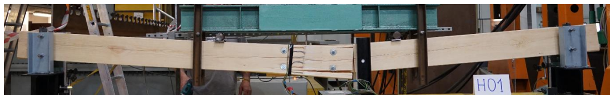
Rys. 5.127. Obraz zniszczenia belki H01
