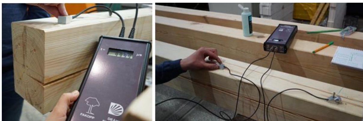
Rys. 4.6. Badania nieniszczące za pomocą urządzenia Fakopp Ultrasonic Timer
