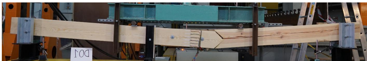
Rys. 5.95. Obraz zniszczenia belki D01
