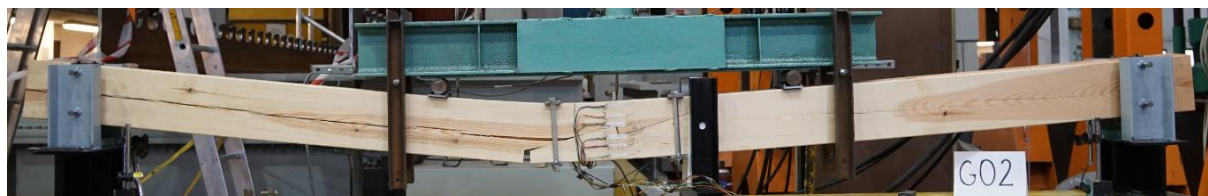
Rys. 5.119. Obraz zniszczenia belki G02
