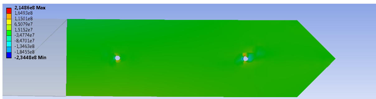
Rys. 5.100. Mapa naprężeń normalnych \sigma_x belki D, powiększenie obszaru złącza przy sile 19 kN
