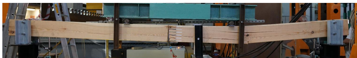
Rys. 5.73. Obraz zniszczenia belki A02
