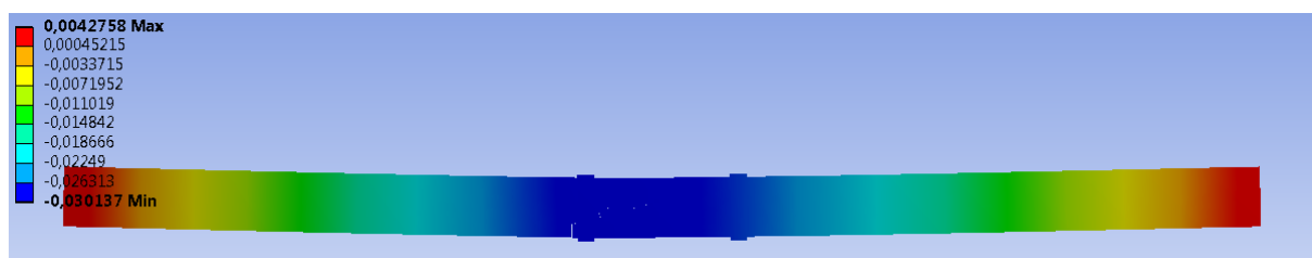
Rys. 5.115. Ugięcie (przemieszczenie w kierunku pionowym y) belki F przy sile 13 kN
