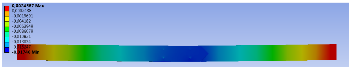
Rys. 5.88. Ugięcie (przesunięcie w kierunku pionowym y ) belki C przy sile 10 kN
