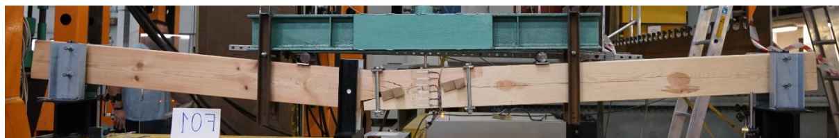
Rys. 5.111. Obraz zniszczenia belki F01
