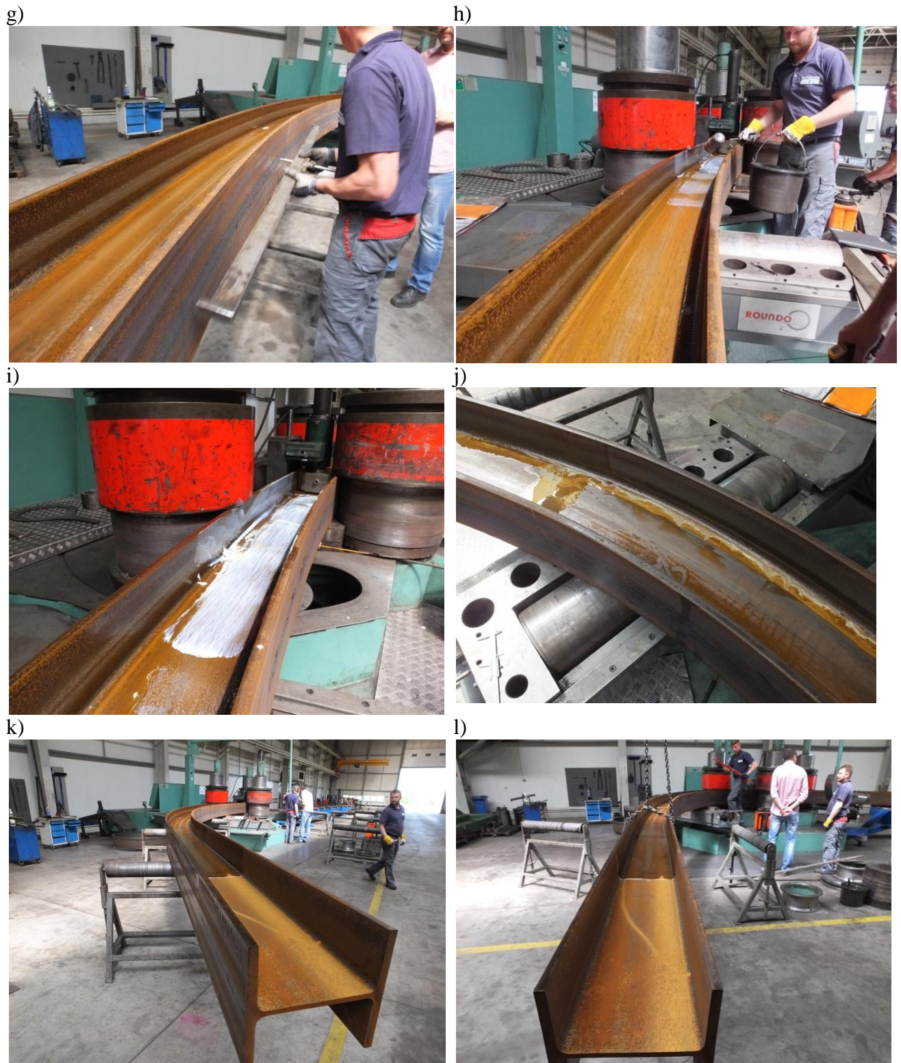
Rys. 4.3.cd Kolejne etapy gięcia na zimno elementu i podział na segmenty badawcze: g) pomiar promienia gięcia, h) pokrycie belki kolejnymi warstwami pasty do niwelacji tarcia, i) widok środka podczas drugiego przejazdu belki przez maszynę do gięcia, j) widok belki po trzecim przejeździe przez maszynę, k) widok boczny elementu po wykonaniu pełnego gięcia, l) widok od czoła elementu po wykonaniu pełnego gięcia
