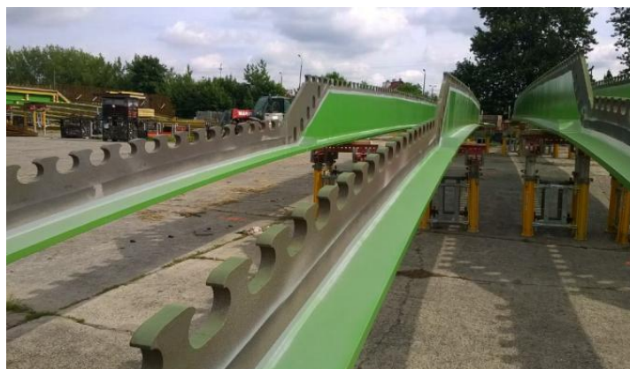
Rys. 8.1. Spawane teowniki z wyciętym kształtem MCL oraz nadanym podniesieniem wykonawczym [Zdjęcie: W. Lorenc]
