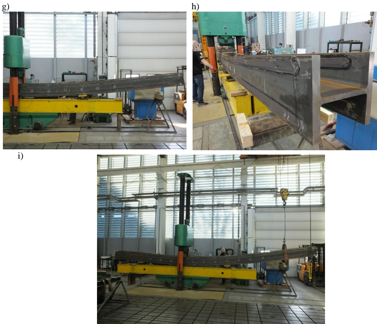
Rys. 6.24. Wybrane etapy badania: a) obciążanie punktu 1, b) obciążanie punktu 2, c) sposób przesuwania belki pomiędzy punktami, d) widok odpadającej wzgorzeliny pod wpływem obciążania elementu, e) obciążanie punktu 4, f) obciążanie punktu 5, g) obciążanie punktu 6, f) obciążanie punktu 6 - perspektywa, g) obciążanie punktu 8, h) widok elementu po gięciu w 9 punktach - perspektywa, i) widok boczny elementu po gięciu w 9 punktach
