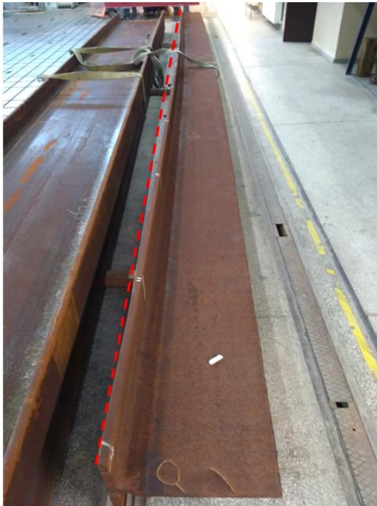
Rys. 5.2. Etapy rozcinania dwuteownika HL110A: a) widok elementu przed rozpoczęciem rozcinania, b) widok po rozcięciu długości 6 m, c) widok po rozcięciu długości 9 m, d) widok po rozcięciu długości 11,8 m, e) widok powstałego teownika po rozcięciu dwuteownika, f) widok deformacji po odcięciu pasa od teownika
