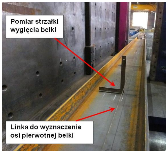
Rys. 2. 23. Weryfikacja trwałego odkształcenia elementu [zdjęcie: Autor]
