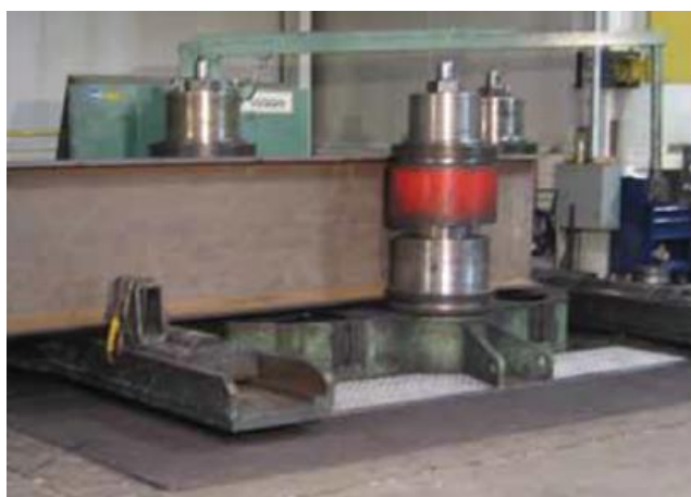
Rys. 2.18. Widok gięcia na zimno metodą rolkową dwuteownika względem słabszej osi [5]
