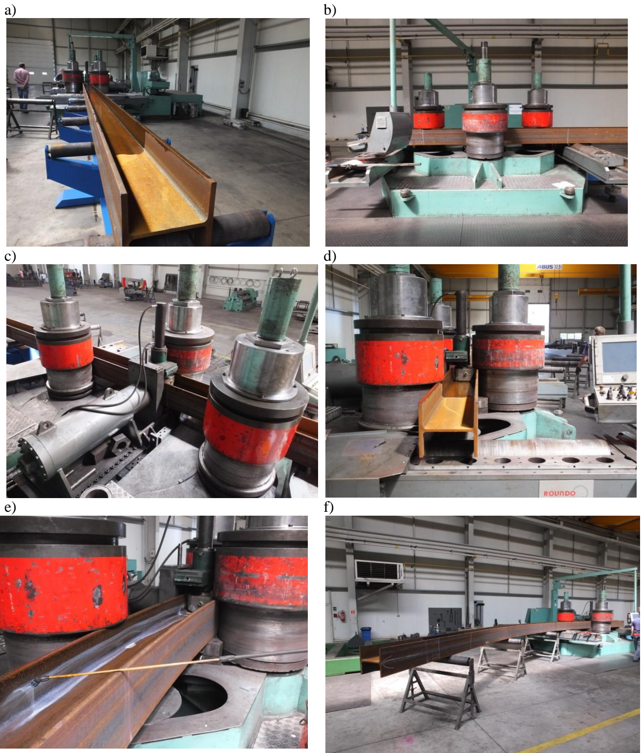
Rys. 4.3. Kolejne etapy gięcia na zimno elementu i podział na segmenty badawcze: a) widok prostej belki przed gięciem, b) widok maszyny do gięcia rolkowego, c) widok siłownika do przytrzymywania przekroju belki, d) widok elementu do stabilizacji środka podczas gięcia, e) nanoszenie warstwy do ograniczenia tarcia, f) widok elementu po pierwszym przejeździe przez maszynę do gięcia
