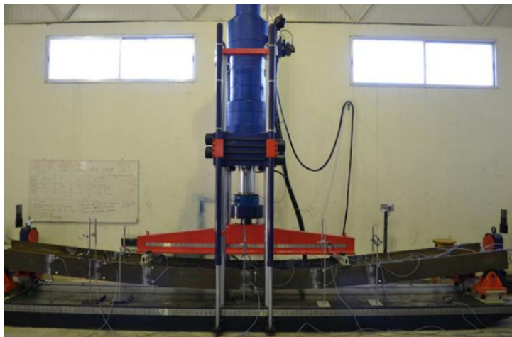
Rys. 2.53. Widok elementu podczas badań laboratoryjnych gięcia na metodą czteropunktowego zginania osi wg [26].
