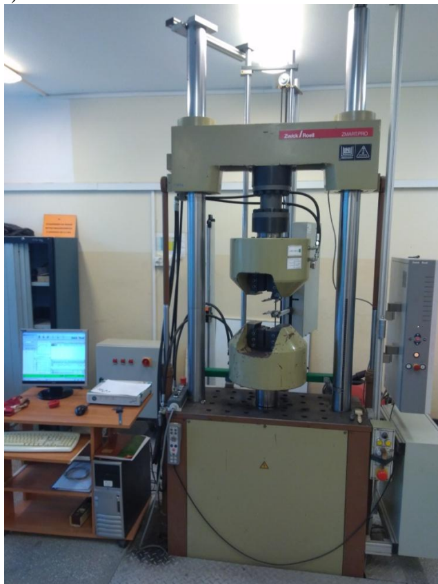
Rys. 4.10. Badanie na rozciąganie próbek: a) maszyna wytrzymałościowa firmy Zwick Roell , b) widok próbek po wykonaniu badań – próbki niewyżarzane
