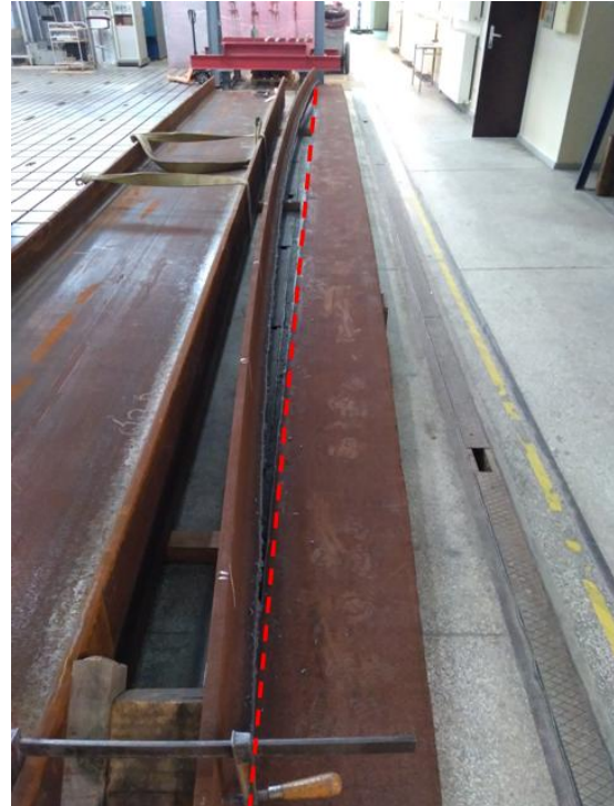
Rys. 5.2. Etapy rozcinania dwuteownika HL110A: a) widok elementu przed rozpoczęciem rozcinania, b) widok po rozcięciu długości 6 m, c) widok po rozcięciu długości 9 m, d) widok po rozcięciu długości 11,8 m, e) widok powstałego teownika po rozcięciu dwuteownika, f) widok deformacji po odcięciu pasa od teownika
