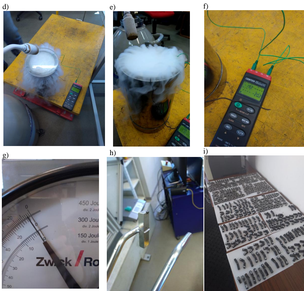
Rys. 4.14. cd Kolejne etapy przeprowadzenia badań udarności: d) chłodzenie próbek ciekłym azotem, e) ciągły pomiar temperatury próbek, f) osiągnięcie docelowej temperatury -20^{\circ}\text{C} , g) wynik tzw. „wolnego przelotu” młota maszyny, h) szczypce do umieszczania próbek na stanowisku pomiarowym, i) widok wszystkich przebadanych próbek na udarność
