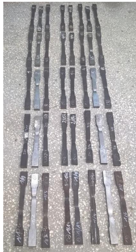
Rys. 4.10. Badanie na rozciąganie próbek: a) maszyna wytrzymałościowa firmy Zwick Roell , b) widok próbek po wykonaniu badań – próbki niewyżarzane
