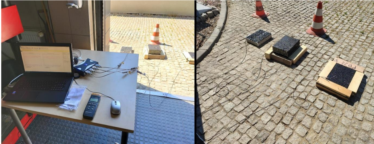
Rys. 88: Eksperymentalne stanowisko do pomiarów temperatury na powierzchni płyt wykonanych z różnych asfaltów - 35/50 WMA i 25/55-80 HIMA
