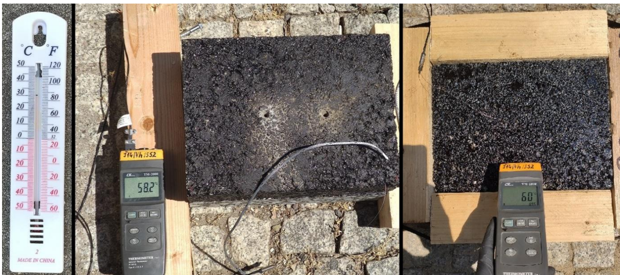
Rys. 89: Pomiary kontrolne z wykorzystaniem różnych mierników i mieszanek (asfalt 35/50 WMA i 25/55-80 HIMA)
