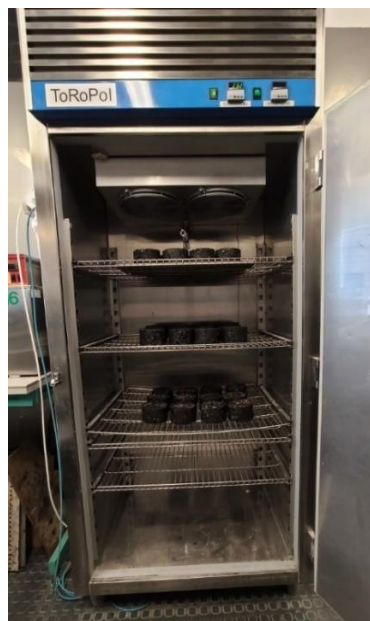
Rys. 41: Komora termiczna wykorzystana do utrzymania docelowej temperatury badania tuż przed testem
