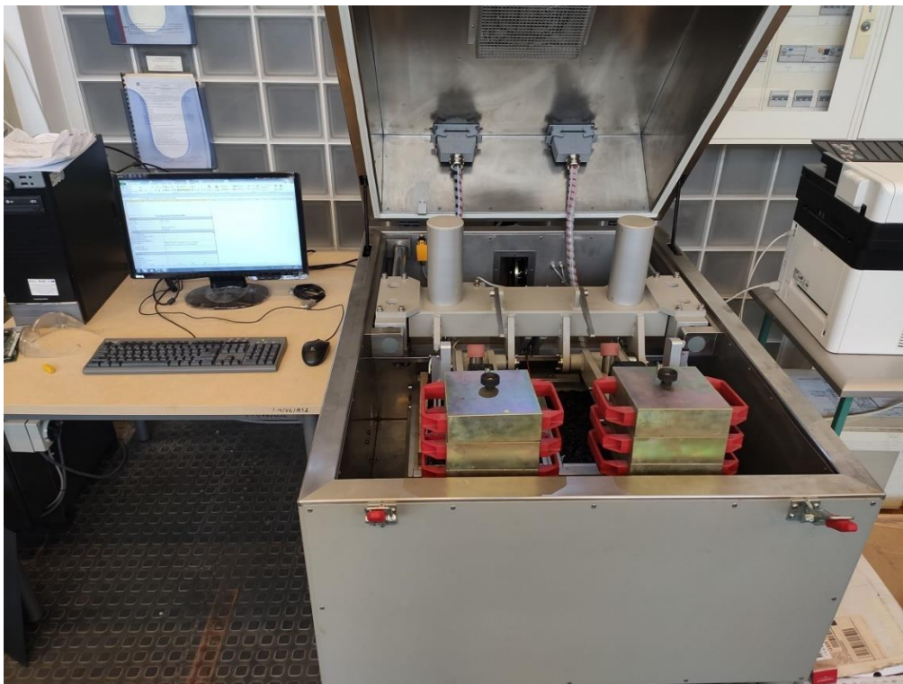
Rys. 47: Stanowisko pomiarowe - podwójna koleiniarka Baustoff
