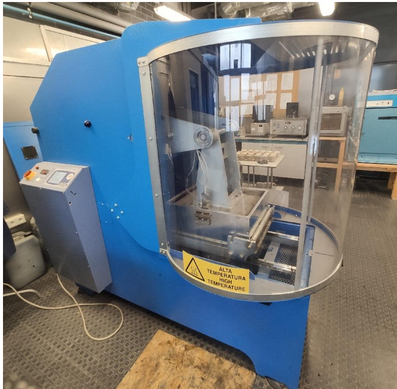
Rys. 32: Zastosowana automatyczna zagęszczarka płytowa
