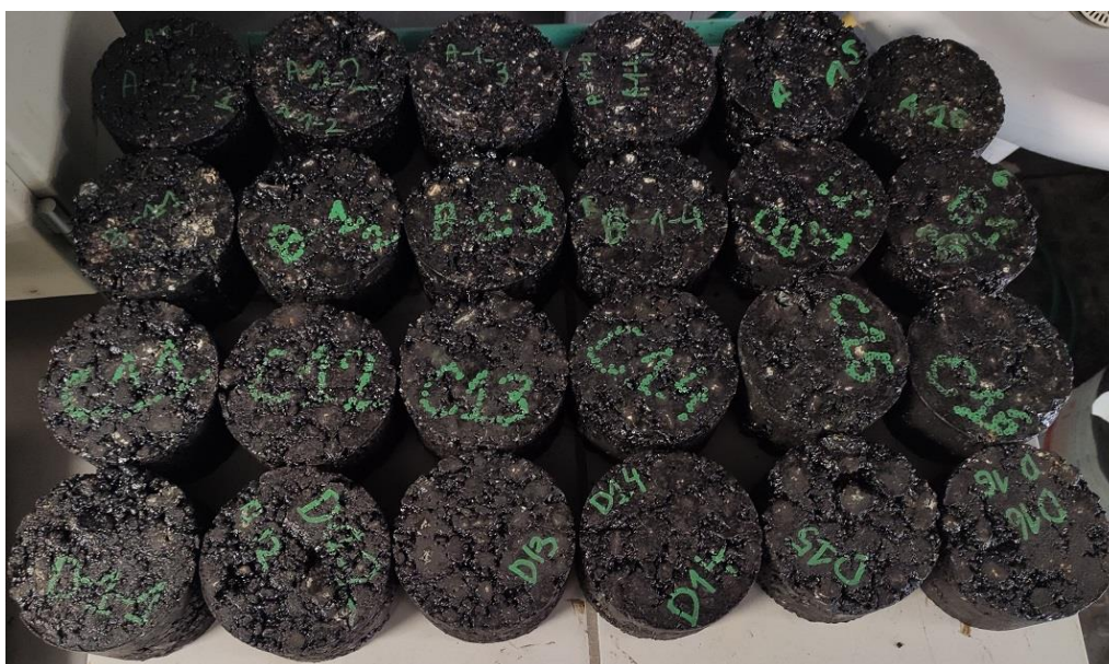
Rys. 36: Przygotowane próbki Marshallowskie do analizy zawartości wolnych przestrzeni; recepta nr 1
