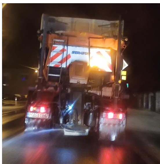
Rys. 66: Solarka posypująca nawierzchnię chlorkiem sodu
