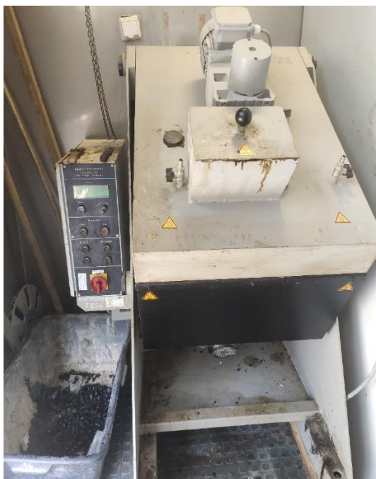
Rys. 30: Mieszalnik laboratoryjny Baustoff
