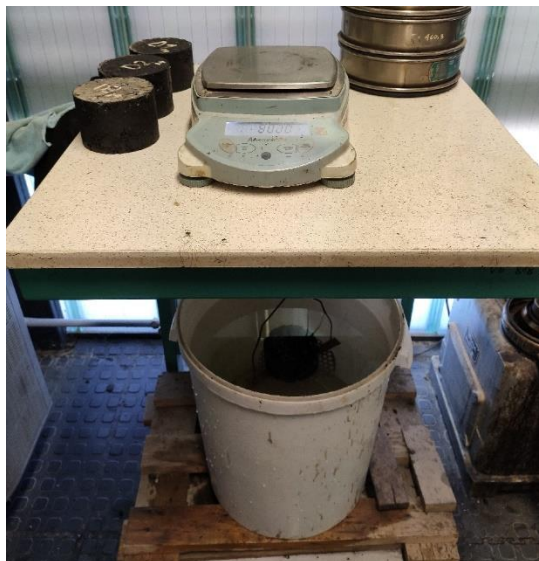
Rys. 37: Stanowisko do pomiaru gęstości objętościowej MMA
