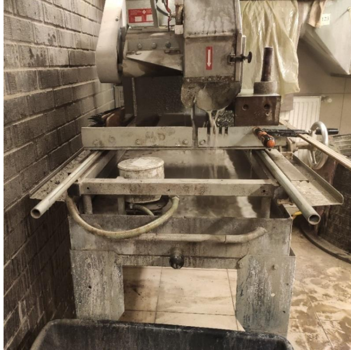
Rys. 33: Zastosowana piła mechaniczna umożliwiająca podwójne cięcie równoległe
