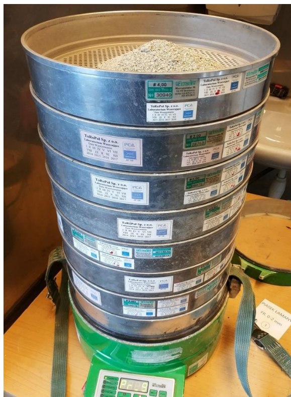
Rys. 27: Stanowisko pomiarowe do analizy uziarnienia
