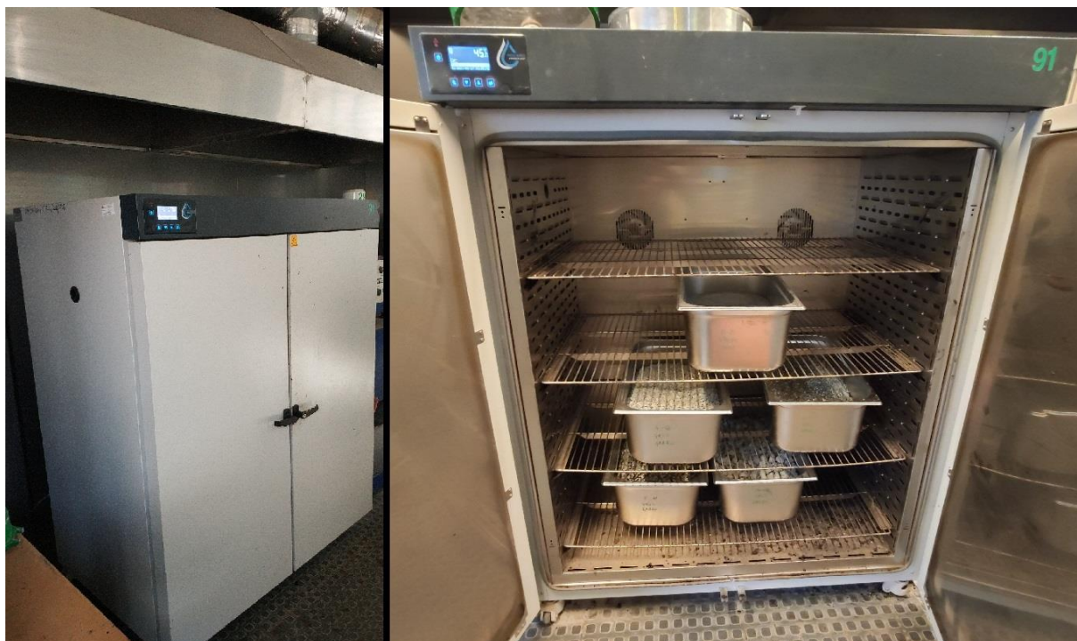
Rys. 29: Suszarka laboratoryjna zastosowana w pracach technologicznych
