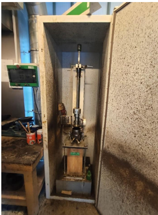
Rys. 31: Zastosowany automatyczny ubijak Marshalla
