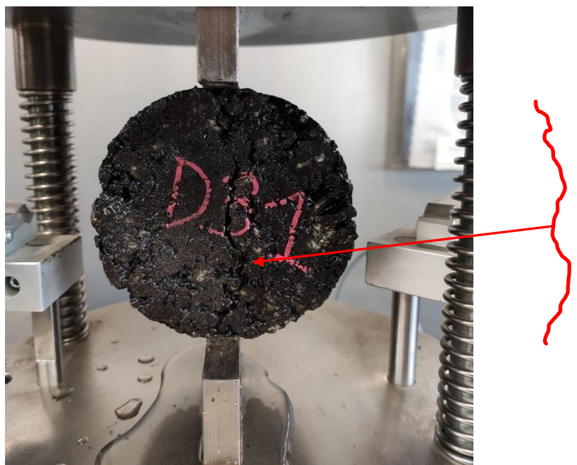
Rys. 43: Próbką walcowa D31 (25/55-80 HIMA) po badaniu ITSR
