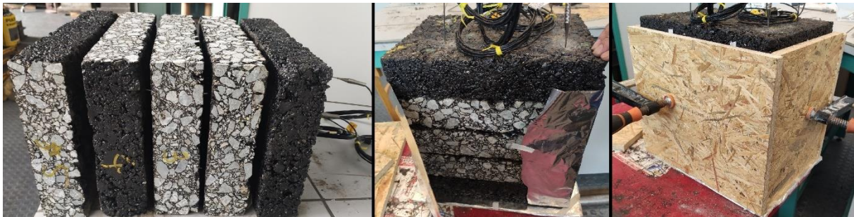
Rys. 92: Budowa eksperymentalnej konstrukcji nawierzchni do pomiarów temperatury z przewiertami o różnej głębokości
