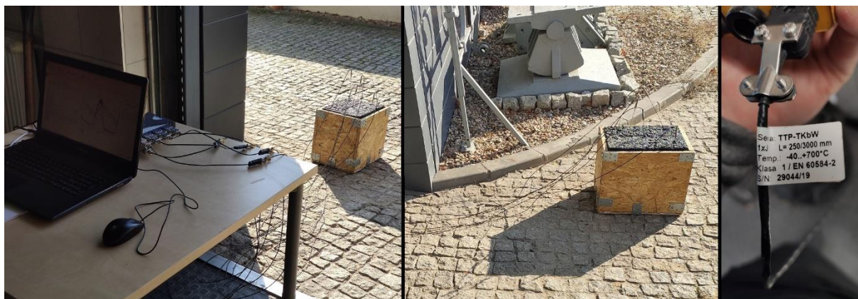
Rys. 93: Eksperymentalny pomiar temperatury na różnych poziomach zagłębienia w układzie warstwowym wykonanym z jednego rodzaju MMA
