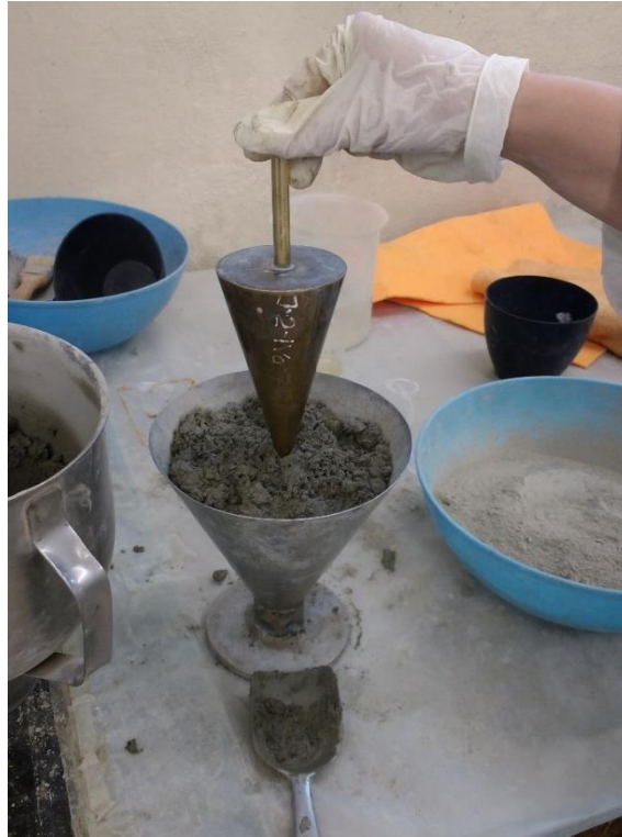
Rys. 36. Widok stanowiska badawczego do badania konsystencji zaprawy metodą opadu stożka Novikowa
