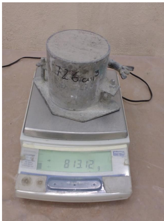
Rys. 37 Widok stanowiska badawczego do badania gęstości objętościowej świeżej zaprawy cementowej
