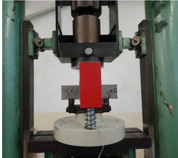
Rys. 40. Widok stanowiska do badania wytrzymałości na rozciąganie przy zginaniu zaprawy cementowej wysokiej wytrzymałości
