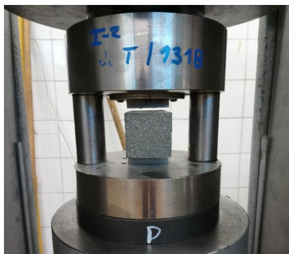
Rys. 39 Widok stanowiska do badania wytrzymałości na ściskanie zaprawy cementowej wysokiej wytrzymałości
