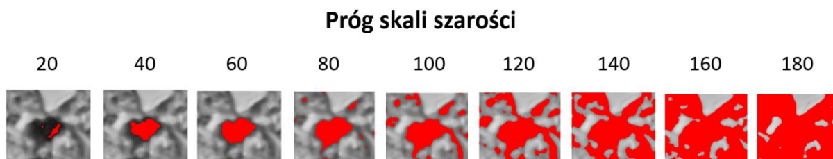
Rys. 48 Zmiany obszaru zaznaczonego na obrazie BSE pojedynczego pora w zależności od wartości progu szarości
