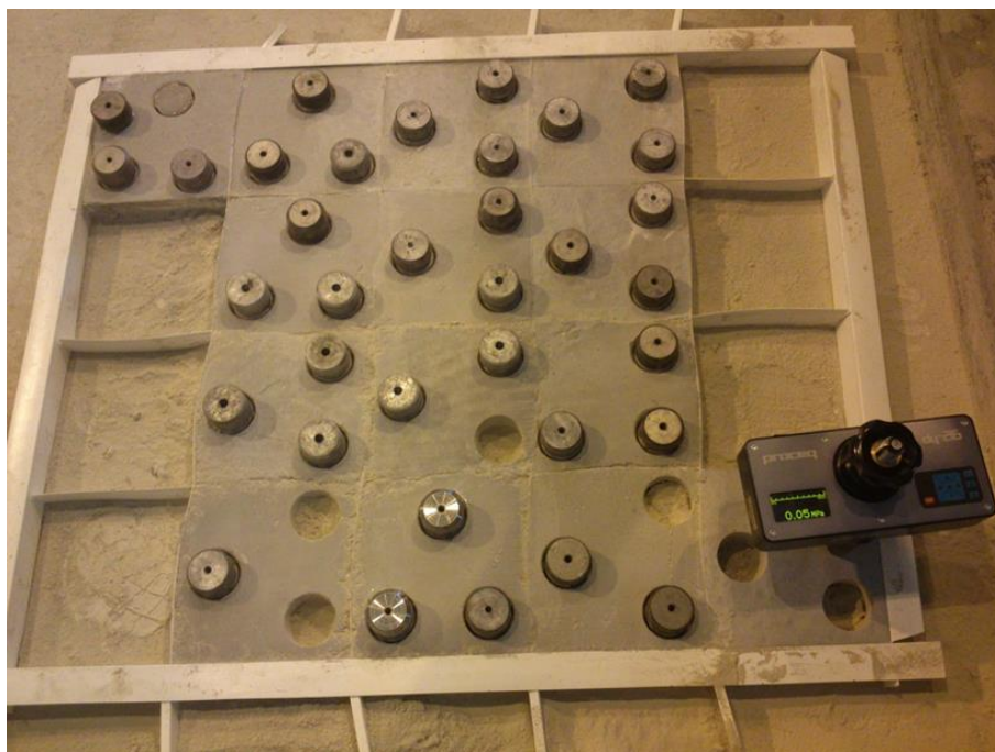
Rys. 44. Widok powierzchni cementowej warstwy wierzchniej podczas badania przyczepności przy odrywaniu warstwy wierzchniej od podkładu
