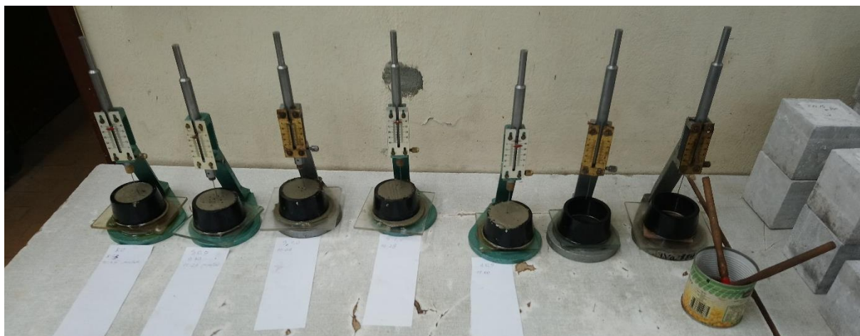
Rys. 38 Widok stanowisk badawczych do badania czasów wiązania aparatem Vicata
