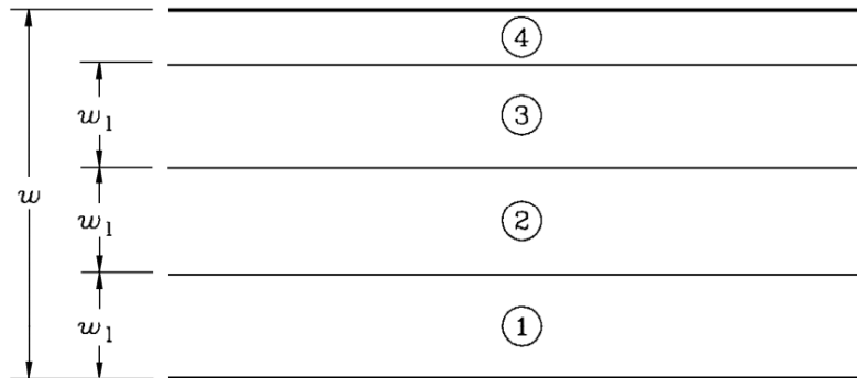
Rys. 1.17. Podział jezdni na pasy umowne i obszar pozostały ( w – szerokość jezdni, w_1 – szerokość pasa umownego, ① ② ③ – numeracja pasów umownych, ④ – obszar pozostały) [68]
