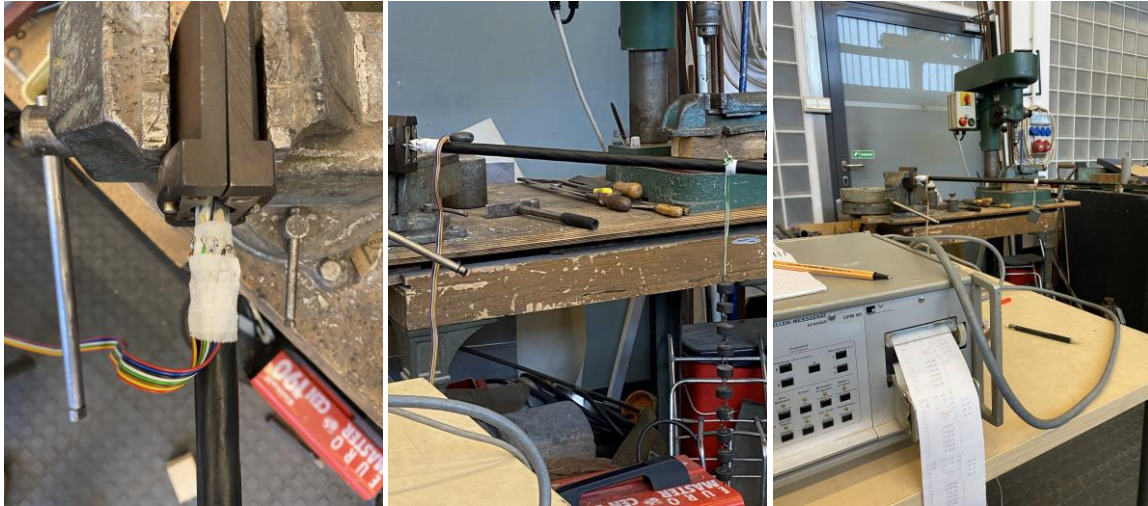
Rys. 4.13. Stanowisko pomiarowe. Od lewej: widoczne podłączenie tensometrów, pręt obciążony odważnikami oraz aparatura rejestrująca pomiary (Hottinger UPM 60)
