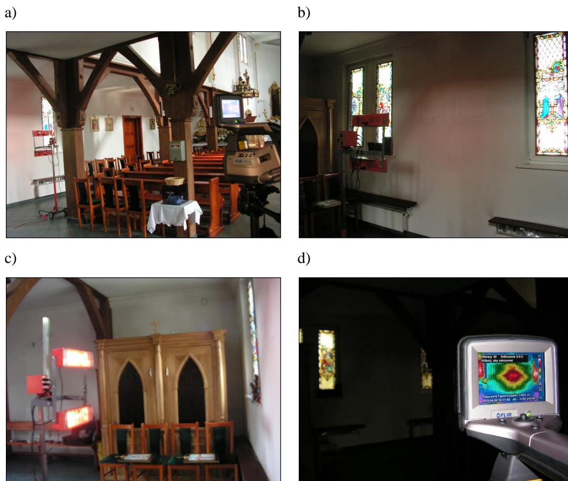
Rys. 6.73. Miejsce wykonania badań terenowych: a) widok ogólny stanowiska, b) widok badanego obszaru przegrody zewnętrznej, c) zbliżenie na promiennik podczerwieni podczas nagrzewu, d) zbliżenie na kamerę termowizyjną podczas cyklicznej rejestracji termogramów
