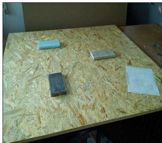
Rys. 6.2. Widok badanego elementu z płyty OSB; a) widok Modelu 3D oraz b) zdjęcie podczas wykonywania elementu; Oznaczenia: 1 – płyta OSB; 2 – wykonany otwór, w który wkładano wtrącenia materiałowe; 3 – termopara; 4 – wtrącenie ze styropianu XPS; 5 – wtrącenia z granitu; 6 – wtrącenie ze stali
