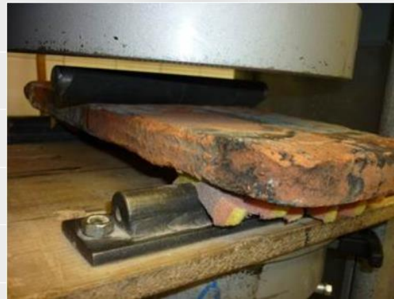
Badania nośności na zginanie
