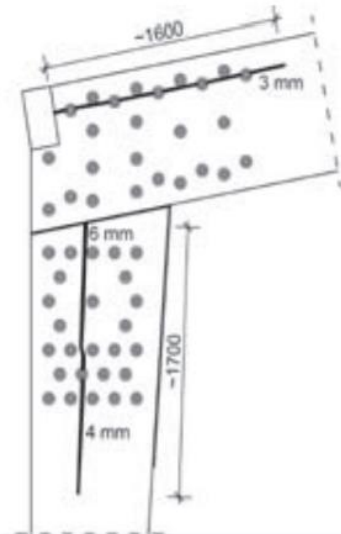
Węzeł narożny. Po prawej stronie zasięg oraz rozwartość rys [mm]
