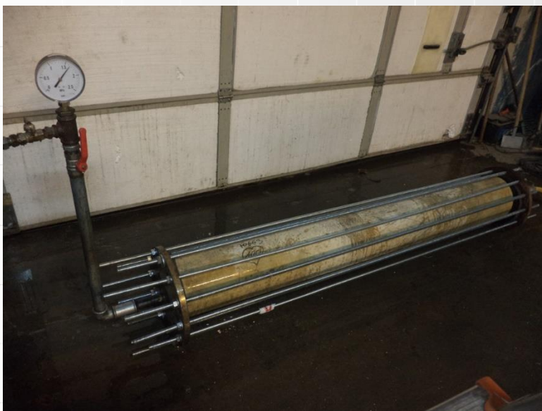
badanie szczelności rury
