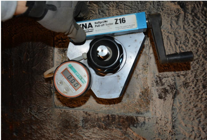
badanie pull-off, przyrząd DYNA Z16
