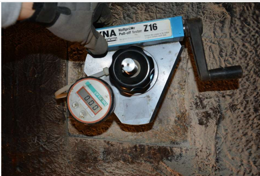
badanie pull-off, przyrząd DYNA Z16
