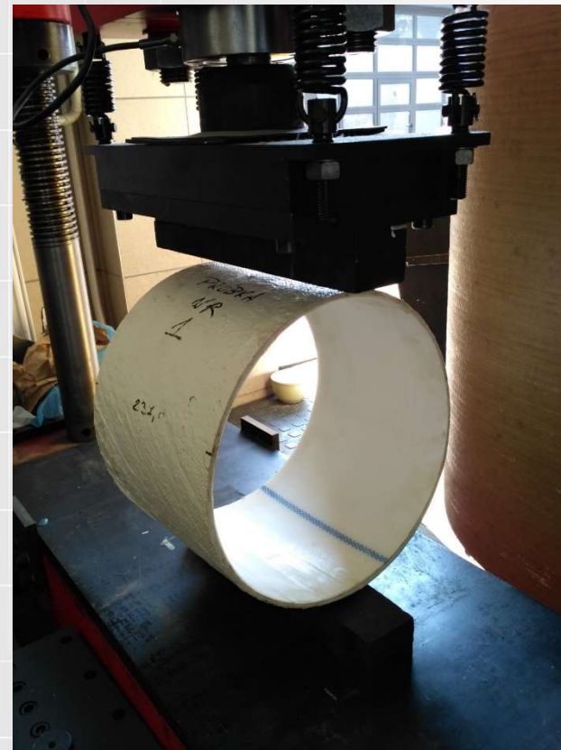
badanie wytrzymałościowe – sztywność obwodowa
