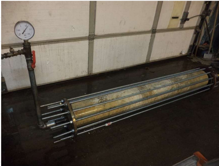
badanie szczelności rury
